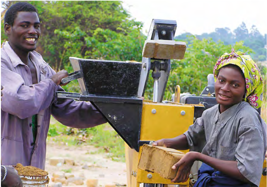
Arbeiten an der Ziegelpresse in Nkwazi (Sambia). Die DESWOS bietet Hilfe zur Selbsthilfe, auch bei der Herstellung von Baumaterialien.
